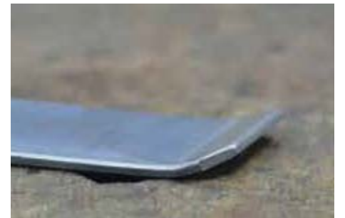
aufgestellte Ende sollen Kratzer vermeiden
