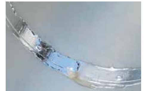
saubere vernietete Lötnaht (ferrinox®4000)
