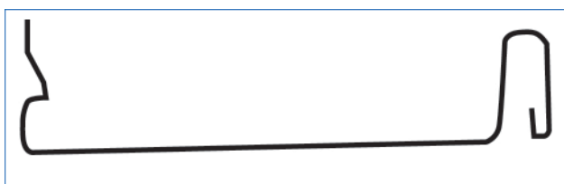
Schnappfalz 25 mm abgeflacht in Österreich 25,40 mm
