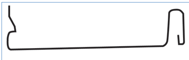
Schnappfalz 25 mm abgeflacht in Österreich 25,40 mm
