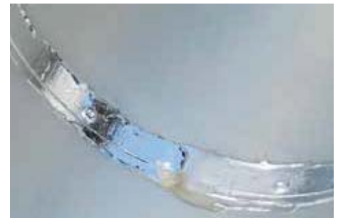
saubere vernietete Lötnaht (ferrinox®4000)
