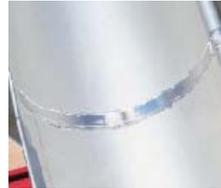
Abschließend die die Lötnaht reinigen
