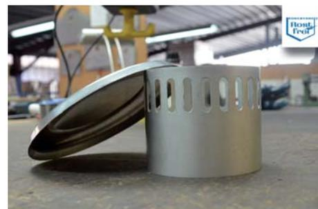
**Bestandteile:** gedrückter Deckel und Unterteil mit Sicke und ausgestanzten Langschlitzen
