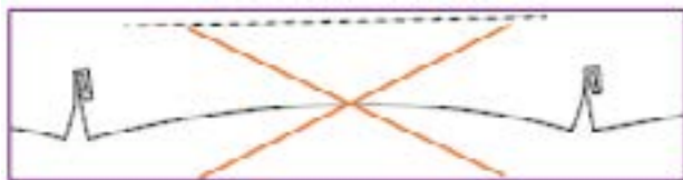
Aufwölbung der Scharen bei zu flachem Aufstellwinkel
